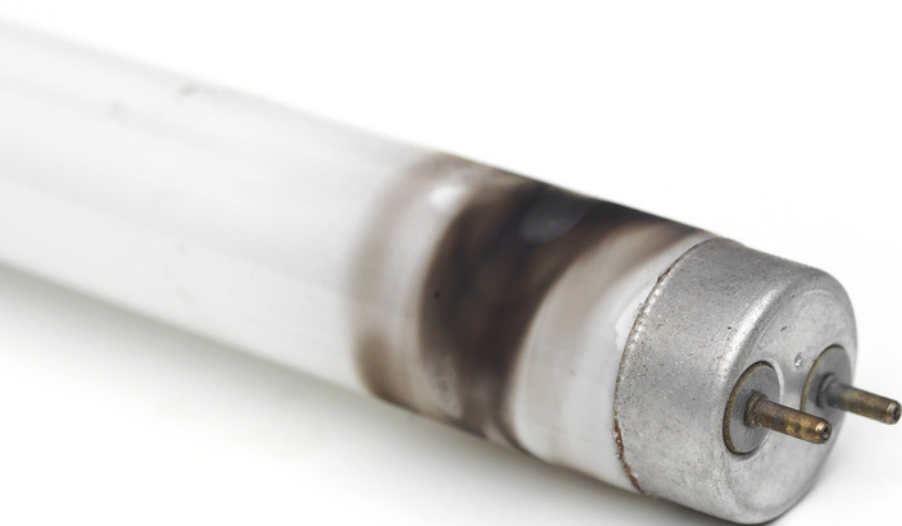
Tube fluorescent en fin de vie montrant des signes de dégradation
